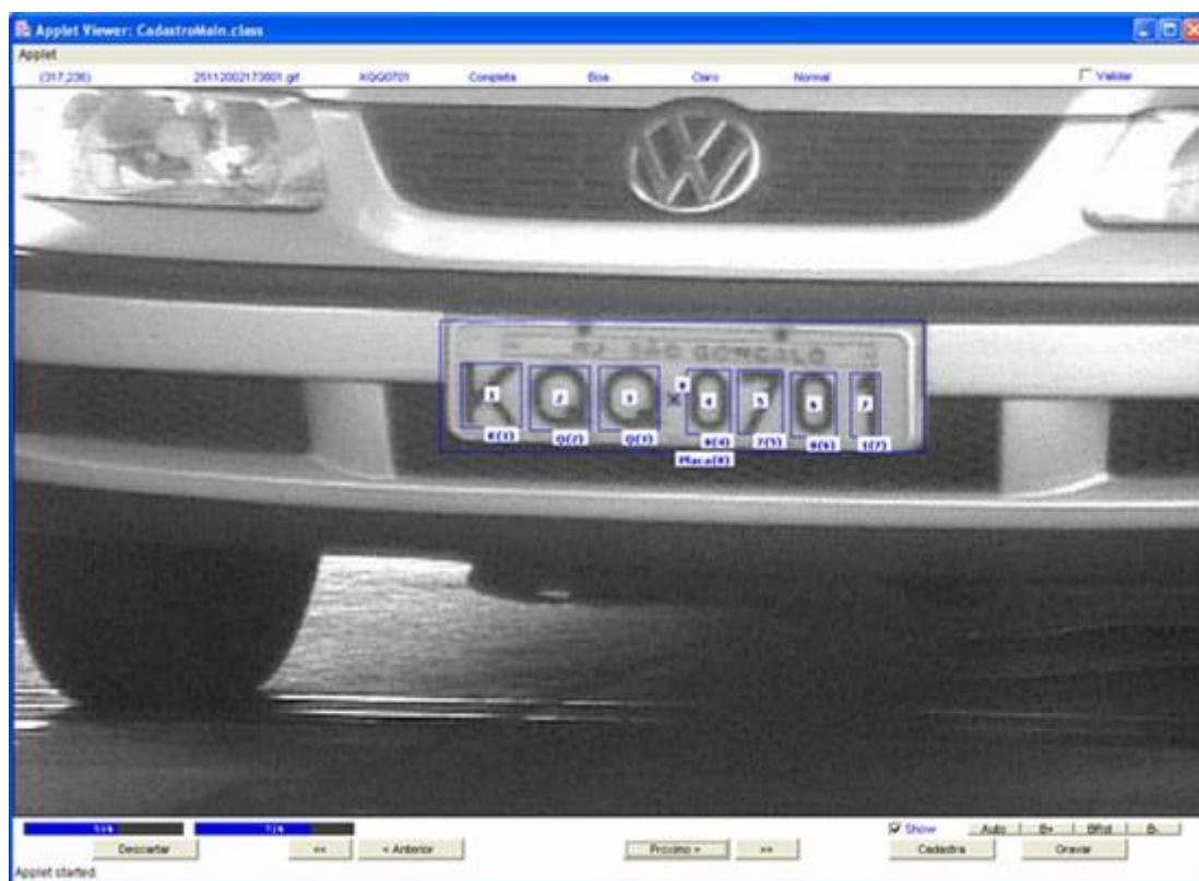
Figura 5. Exemplo de leitura de placa usando OPENCV
